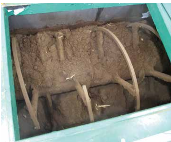
有害鳥獣の猪などをおがくずと混ぜて分解する装置
