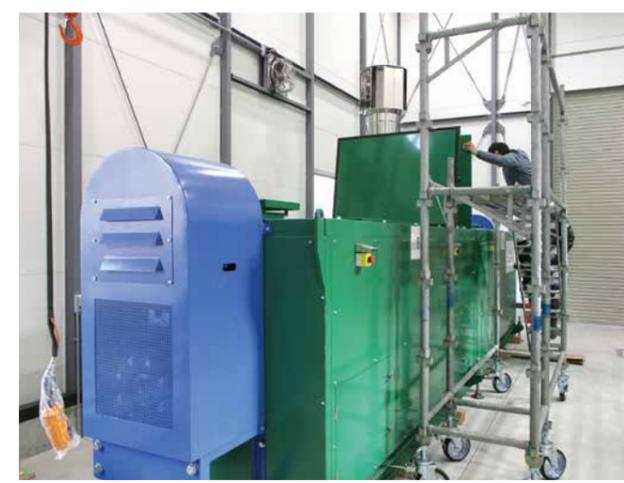
有害鳥獣減容化処理施設の捕獲イノシシ等を分解する処理装置
