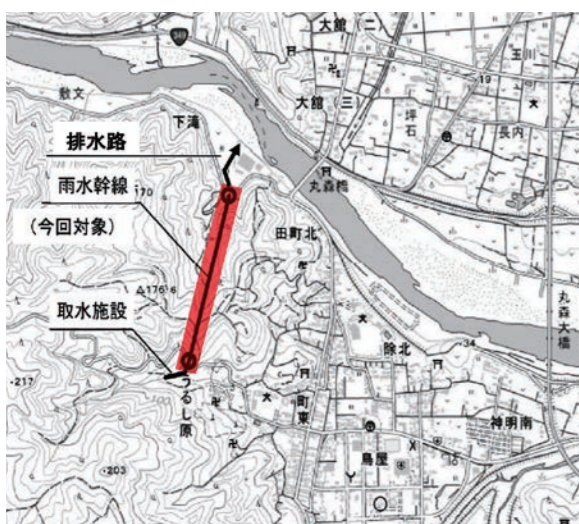
浸水防止に大きな効果が期待される雨水直接放流管
