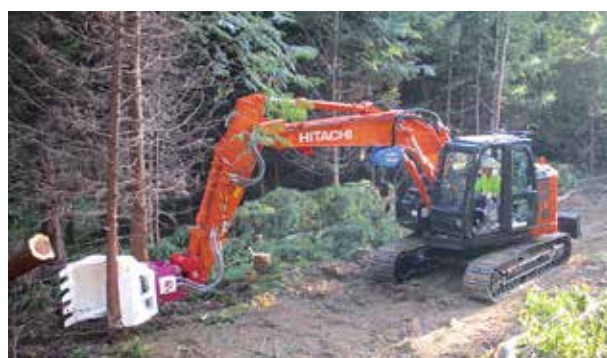
フェラーバンチャ（高性能林業機械）による作業の様子
