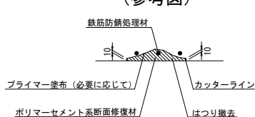
断面修復工標準図 (参考図)
